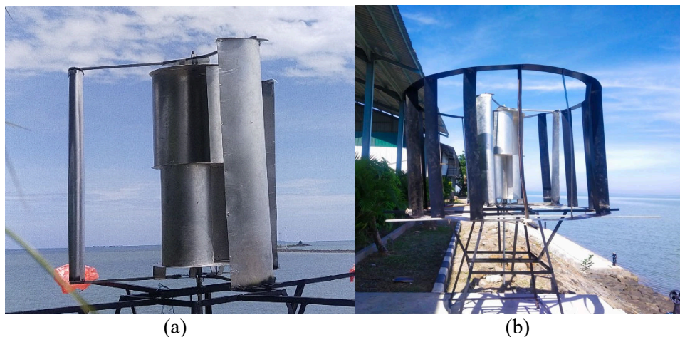
Gambar 4. Konstruksi VAWT tipe Hybrid Savonius-Darrieus (a) tanpa Wind Deflector dan (b) dengan Wind Deflector
