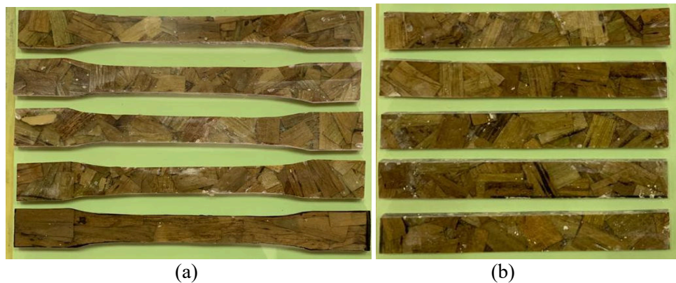
Gambar 7. Hasil pembuatan spesimen uji: (a) Uji tarik, (b) Uji bending
