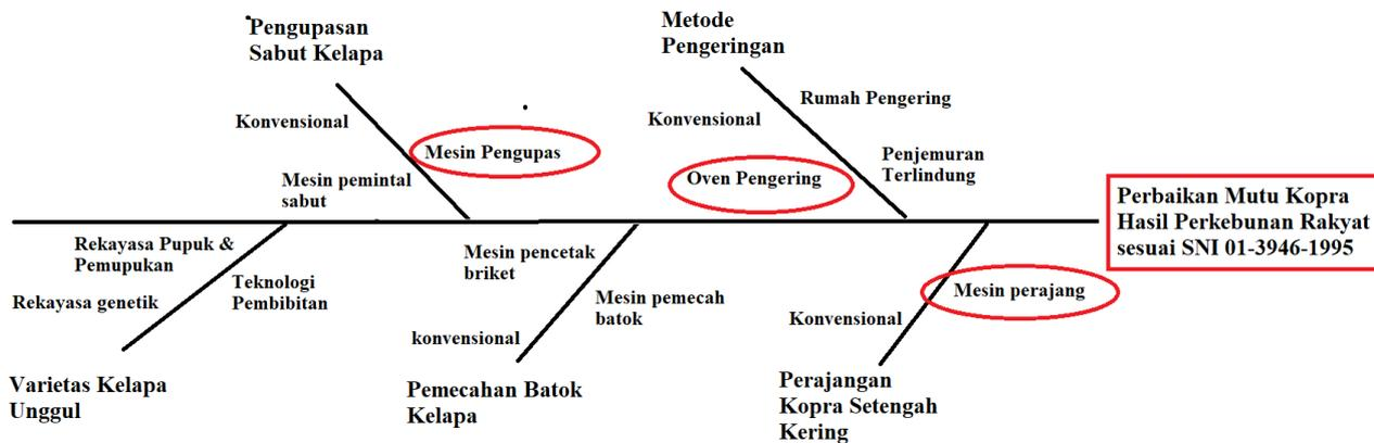
Gambar 2: Identifikasi kegiatan yang diperlukan untuk perbaikan mutu kopra hasil perkebunan rakyat (*fishbone* diagram)
