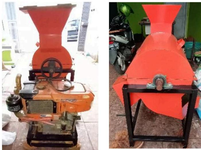
Gambar 3. Mesin Pengurai serat sabuk kelapa
