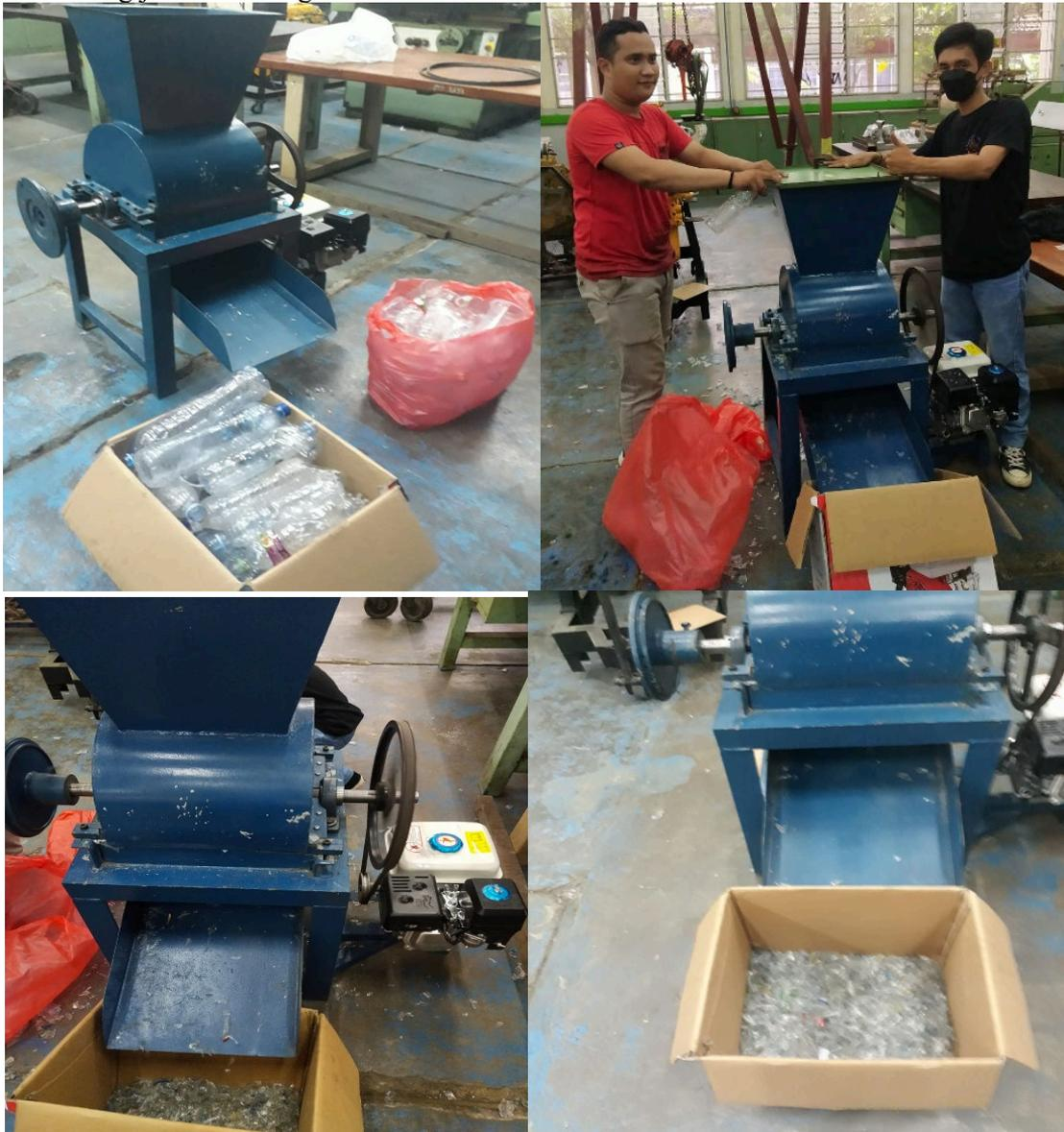
**Gambar 3.2 Pengujian Mesin Pencacah sampah botol plastik**
