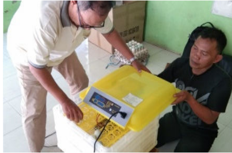
Gambar 4. Penempatan telur pada mesin tetas telur otomatis
