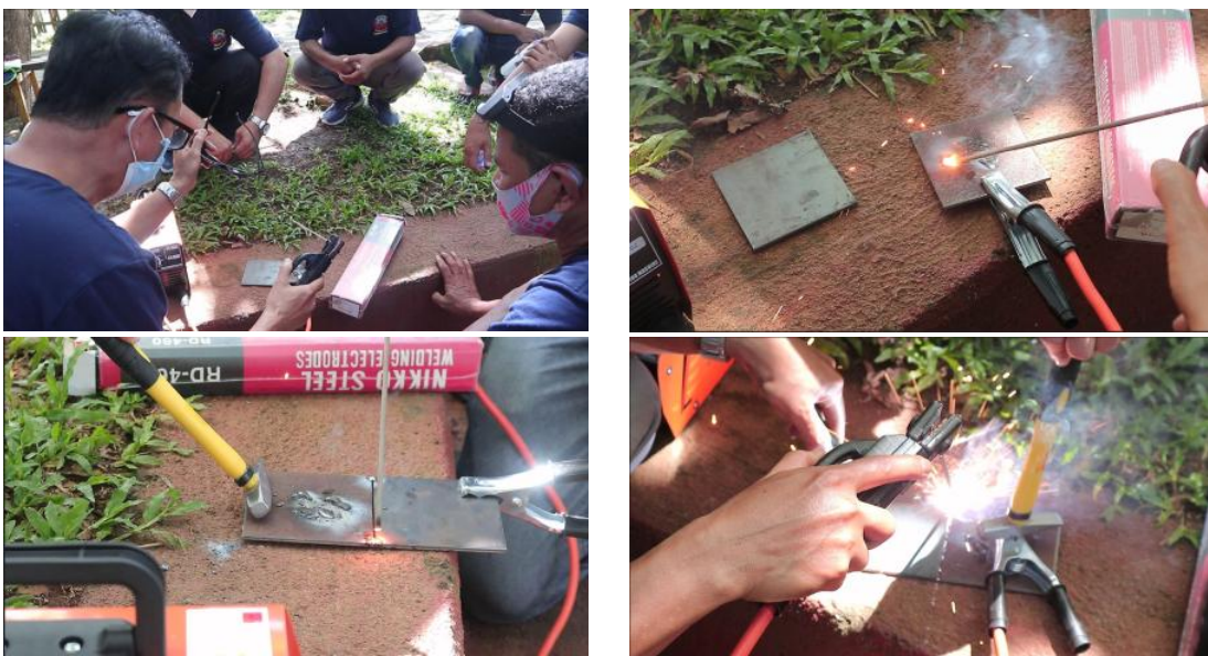
Gambar 6. Penjelasan cara menghidupkan lengkung/busur listrik
