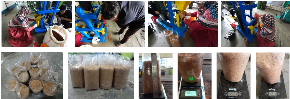
Gambar 4. Pengambilan data pengujian dan Pengukuran massa jenis baglog
