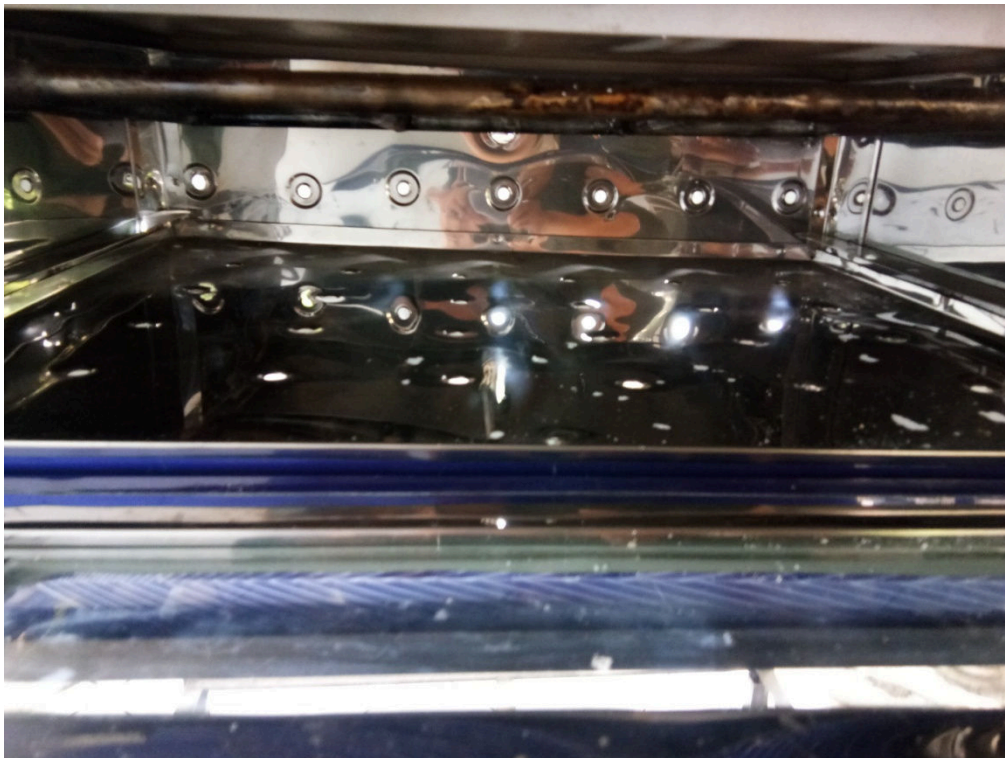
Gambar 3. Ruang Tungku Pembakaran
