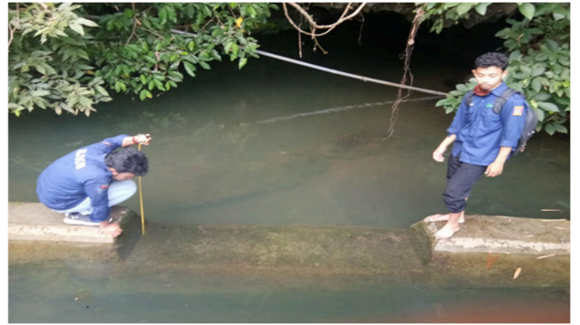
Gambar 4 Pengukuran Luas Penampang Aliran Air
