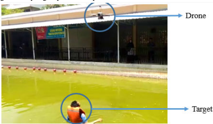
Gambar 10 Posisi drone dan target pada pengujian drone untuk mendeteksi target di permukaan air
