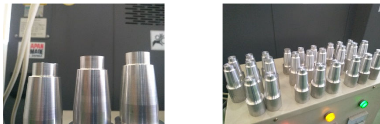
Gambar 5. Benda kerja hasil CNC tirus divergen.
