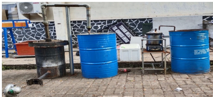
Gambar 2. Alat penghasil asap cair terintegrasi dengan memanfaatkan energi biomassa
