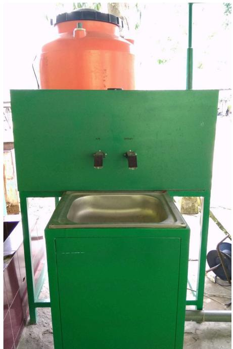
Gambar 4. Sistem alat cuci tangan otomatis
