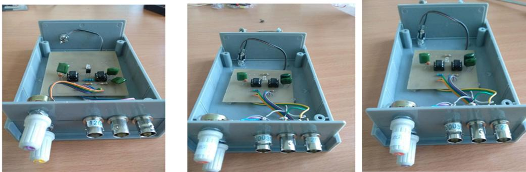
Gambar 3. Casing (kemasan) modul Modulasi digital (ASK, FSK dan BPSK)
