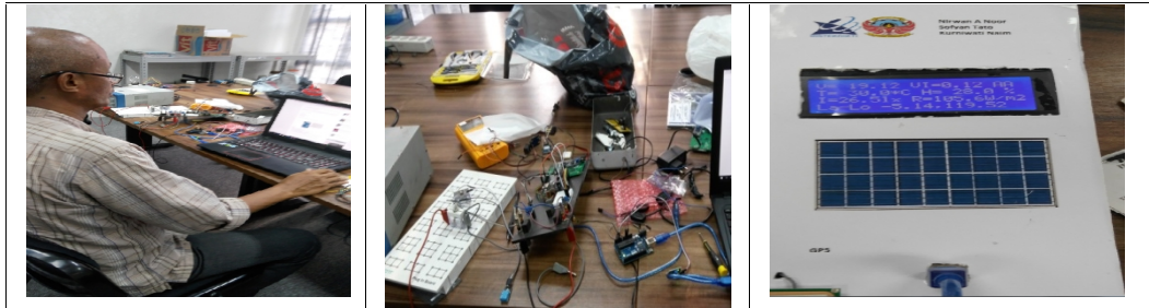
Gambar 3 Kondisi Saat Perakitan dan Modul prototipe Alat ukur Solar Panel yang telah dirakit
