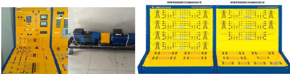
Gambar 1. Simulator sumber pembangkit generator sinkron, PLN dan jaringan distribusi
