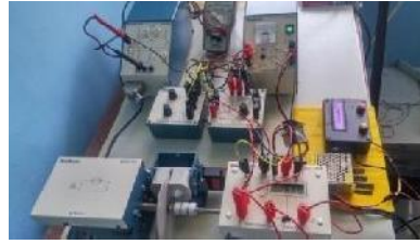
Gambar 8 Ujicoba Sistem Kontrol Loop Tertutup Dengan unit pembebanan otomatis
