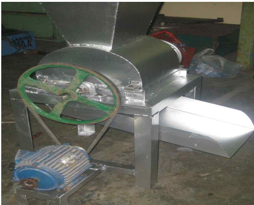
Gambar 3. Alat Pencacah Botol dan Gelas Plastik
