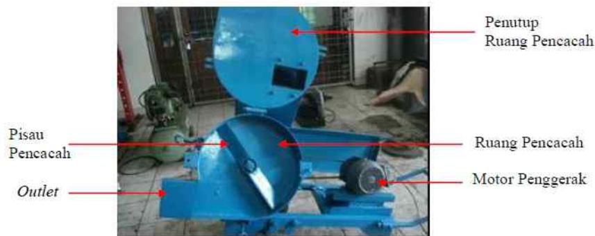
Gambar 4. Mesin pencacah rumput gajah untuk pakan ternak
