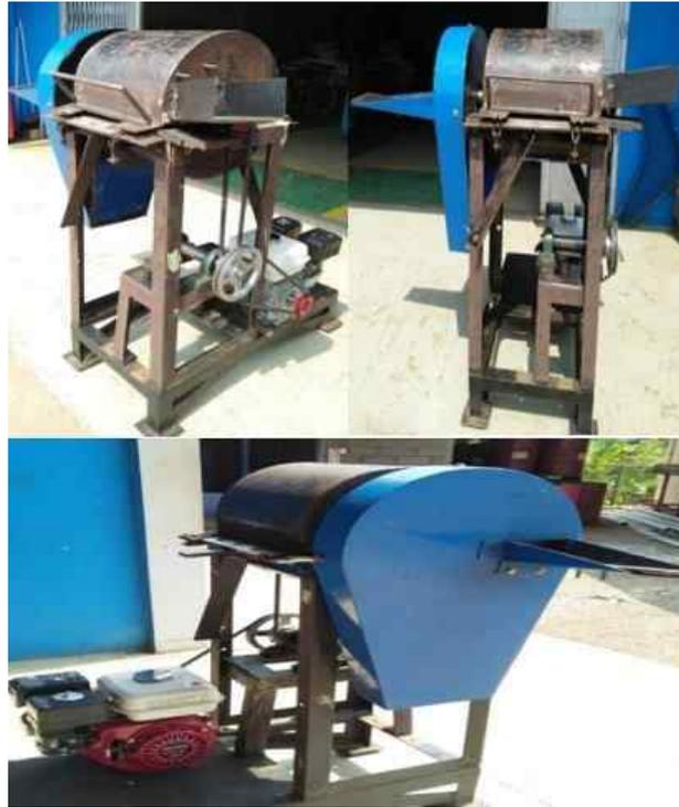
Gambar 8. Mesin pencacah rumput dengan dua saluran masuk dan satu saluran keluar
