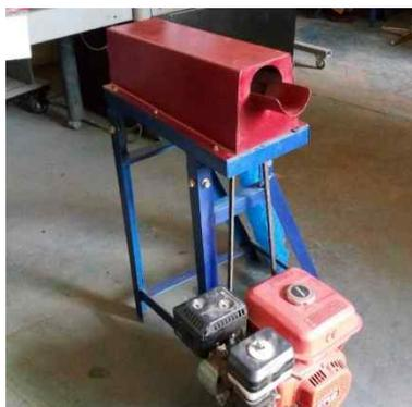
Gambar 3. Prototype mesin pemipil jagung kapasitas 200Kg/jam.
