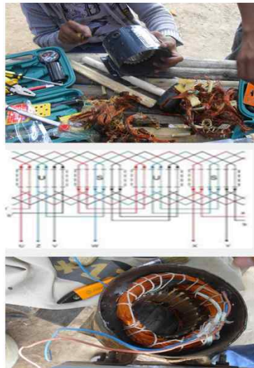
Gambar 1 Tahapan Rewinding Motor Induksi
