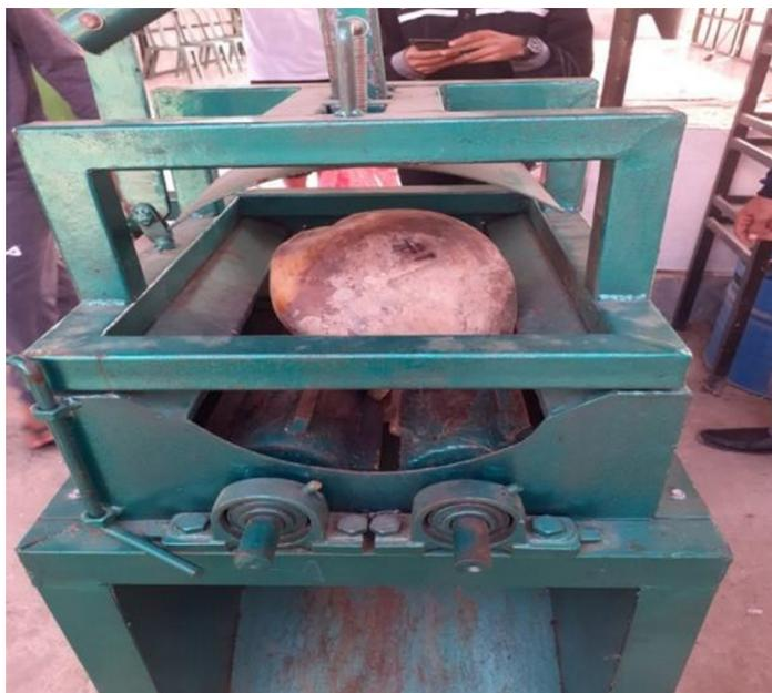
Gambar 5. Proses Pengupasan Sabut kelapa pada Mesin Pengupas Sabut Kelapa
