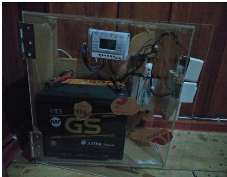
Gambar 4. Hasil alat teknologi sistem penerangan tenaga surya yang diterapkan
