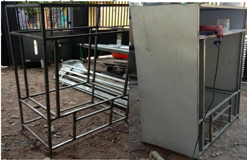
Gbr. 3.2 Pembuatan Rangka Oven Pengering Pakan Ikan
