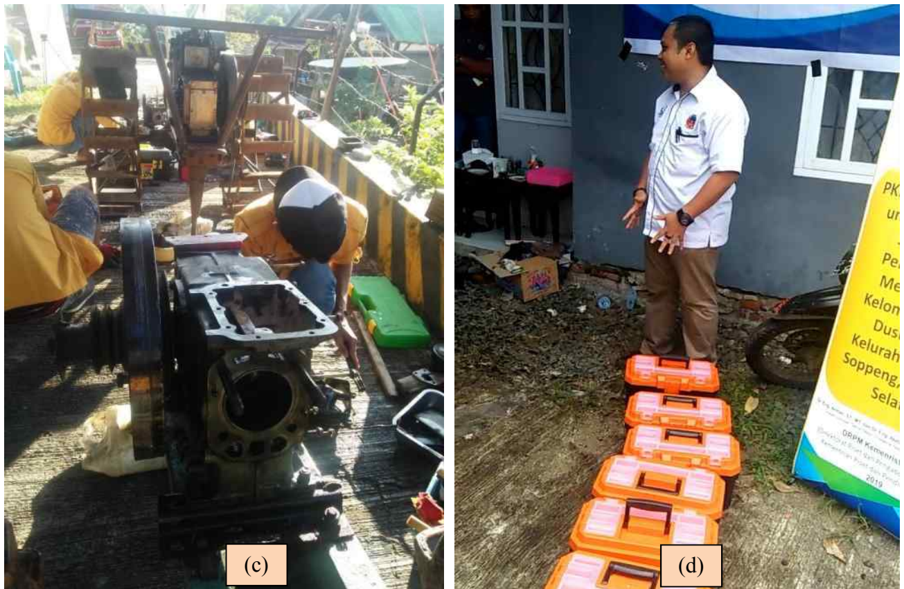
Gambar 4 Foto pelaksanaan overhaul engine traktor tangan di Soppeng 30/4/2019 – 1/5/2019, (a) pelaksanaan overhaul (pembongkaran) (b) Pelaksanaan overhaul (pemeriksaan) (c) Pelaksanaan overhaul (pemasangan) tiga mesin traktor petani dan (d) dan penyerahan alat servis 6 set kunci-kunci untuk pelaksanaan overhaul mesin traktor petani di Soppeng
