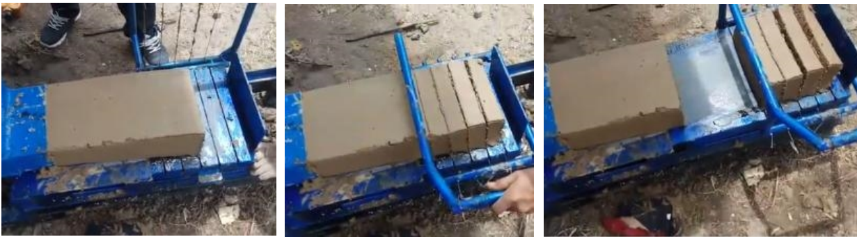
Gambar 3. Proses pencetakan batu bata
