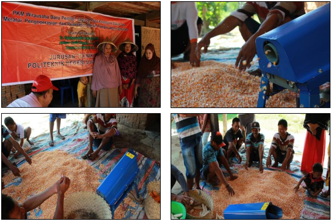
Gambar 3. Penjelasan cara mengoperasikan alat dan proses pemipilan jagung.
