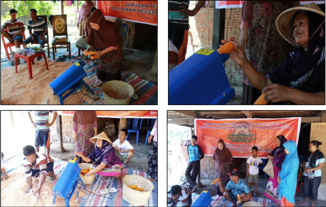
Gambar 4. Pengoperasian mesin pemipil jagung oleh anggota kelompok wanita tani.
