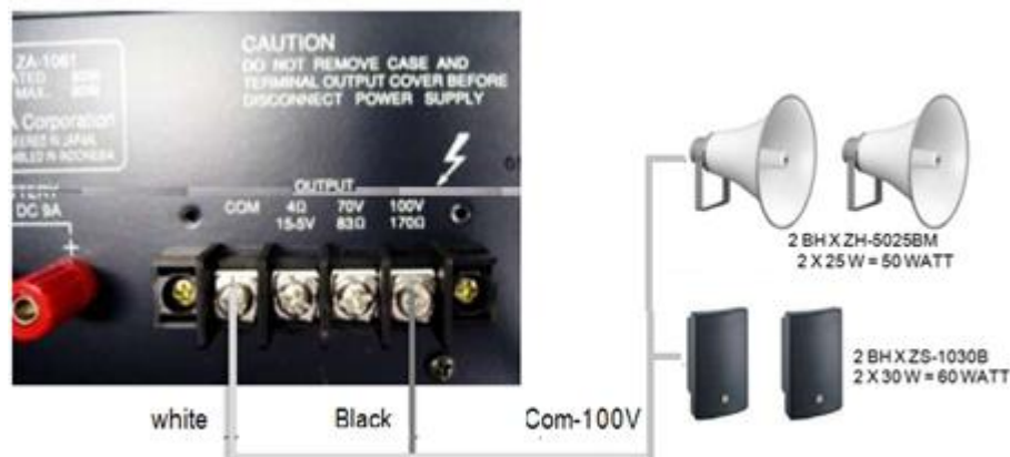
Gambar 9. Pemasangan Speaker High Impedance pada Amplifier
