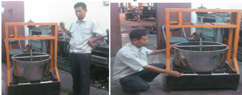
Gbr. 3.3. Hasil Pembuatan Mesin Pengaduk dan Pemasak Gula Aren Semut
