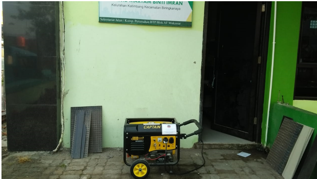
Gambar 3. Peralatan generator-set sebagai CDP
