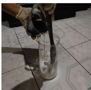
Gambar 10. Pencampuran NaOH dengan air arang tangkai padi yang telah disaring
