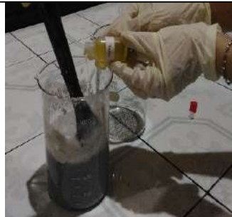
Gambar 9. Penambahan sedikit NaOH dilarutkan dalam air
