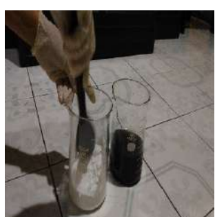
Gambar 10. Pencampuran NaOH dengan air arang tangkai padi yang telah disaring
