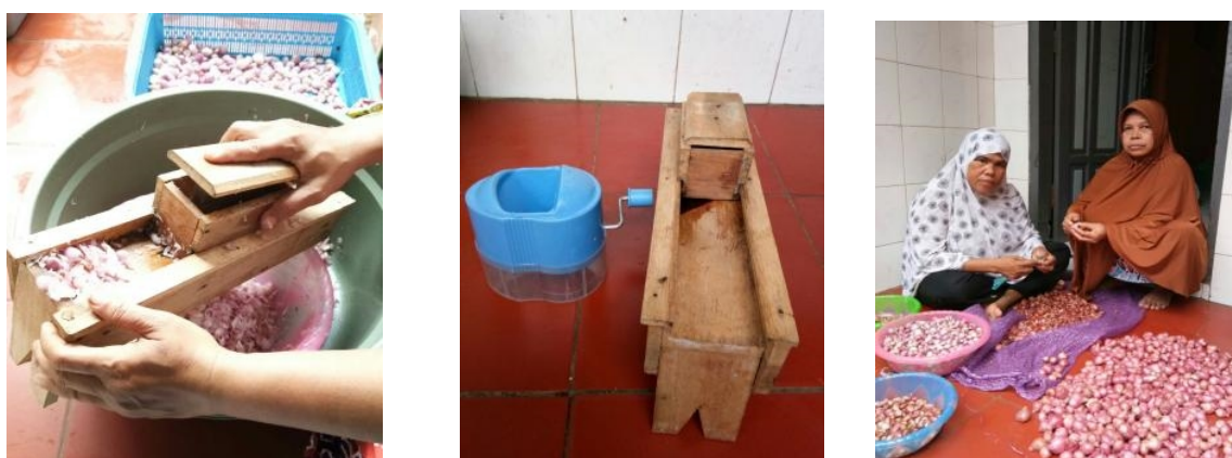
Gambar 1. Mesin pemotong manual bawang merah yang masih sederhana dan mengupas bawang masih secara manual.
