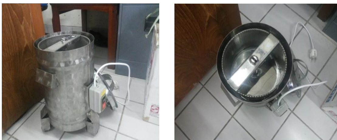
Gambar 3. Mesin Spinner untuk Pemaseras Minyak dari Bawang Goreng, Kap. 3,5 ltr
