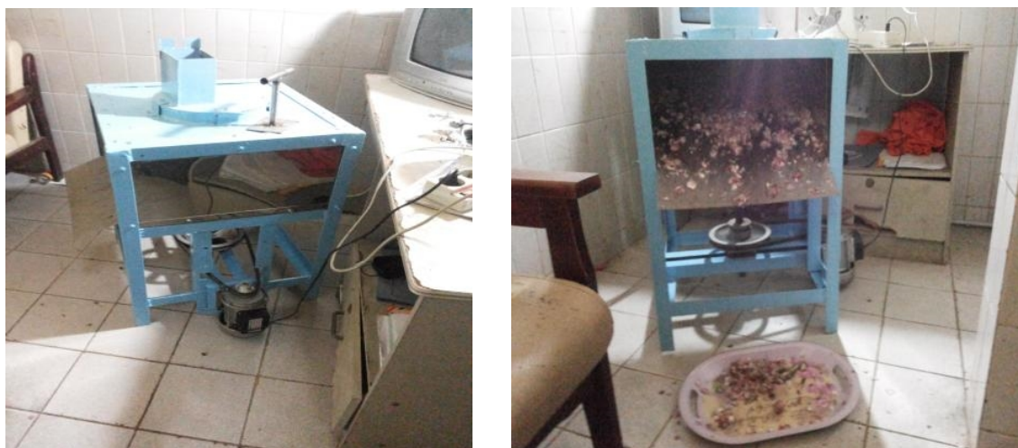
Gambar 2. Mesin Pemotong/Pengiris Bawang, Kap. 50 kg/jam
