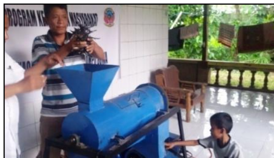
Gambar 4. Uji coba mesin pengupas dan pemisahan kulit kacang hijau
