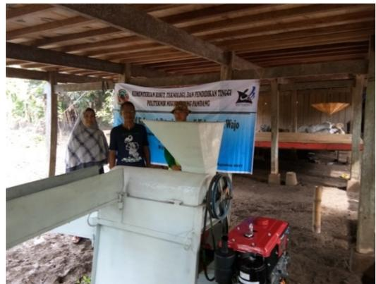
Gambar 3. Kondisi mesin pemipil jagung setelah uji coba
