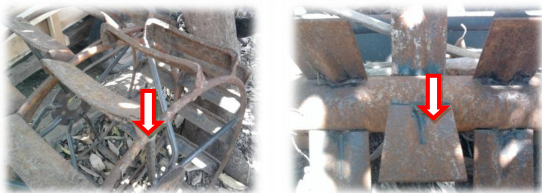
Gambar 2. Bagian sambungan sirip roda besi dan peralatan lain yang sering rusak.
