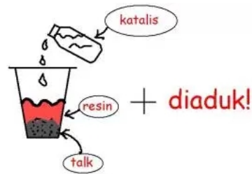
Gambar 3. Pembuatan campuran resin, talk dan katalis pengering
