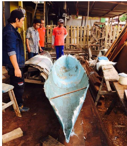
Gambar 5. Hasil Perahu komposit fiber glass sebelum difinishing
