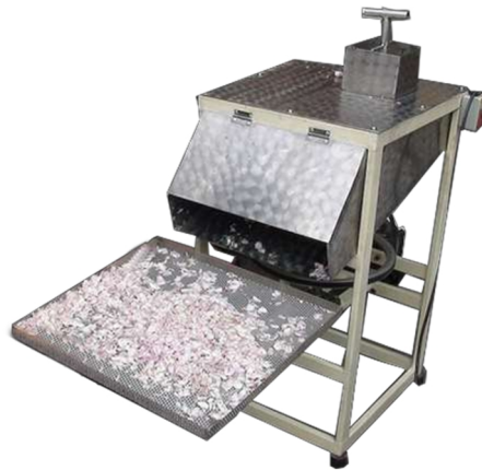
Gambar 1. Konstruksi mesin pengiris bawang merah
