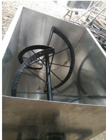
Gambar 4. Mesin Pencampur Bahan Baglog Tampak Atas
