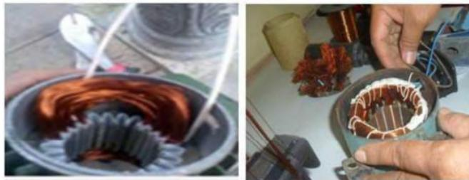
Gambar 6 Memasukkan kawat email Ke alur stator dan diikat dengan benang
