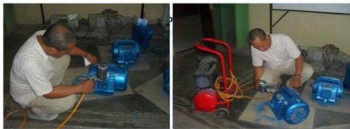
Gambar 8 Pengecatan Motor Hasil Rekondisi dan rewinding
