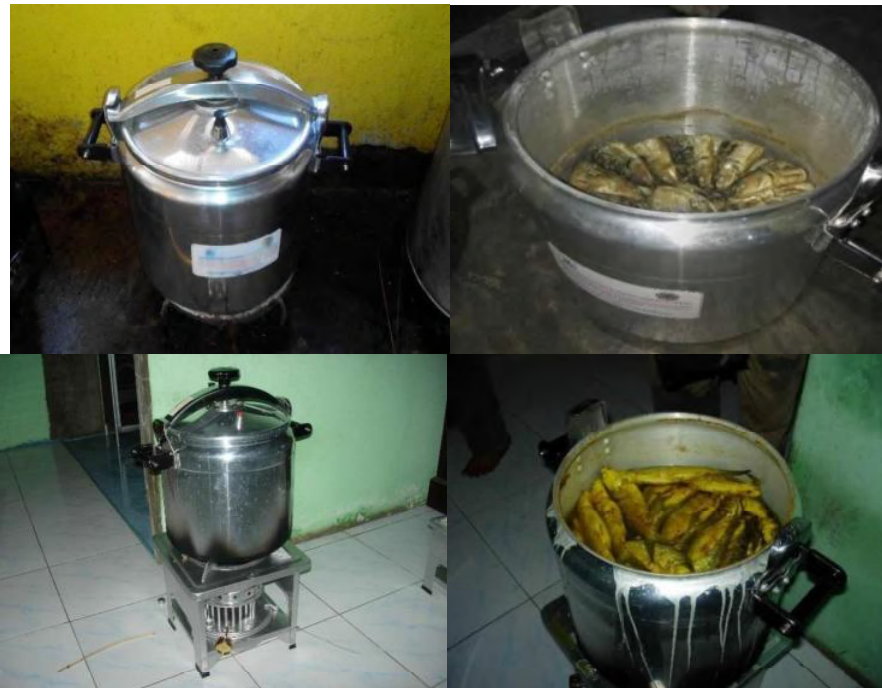
Gambar 5.2 Penerapan alat memasak menggunakan panci presto kapasitas 36 liter.
