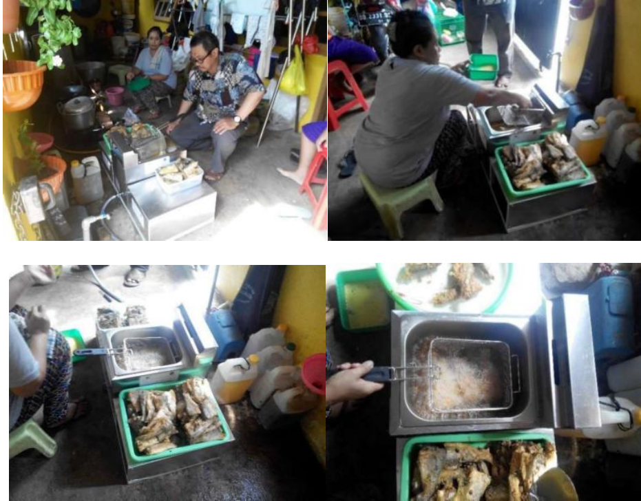
Gambar 5.3 Penerapan alat menggoreng kapasitas 5-6 potong ikan bandeng.
