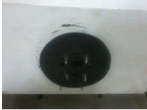
Gambar 3. Pemegang Kentang Yang Berputar Saat Pemotongan.
