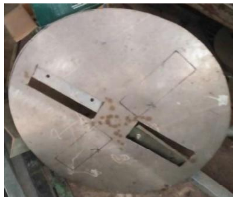
Gambar 2. Piringan Pemotong Dan Posisi Mata Potongnya
