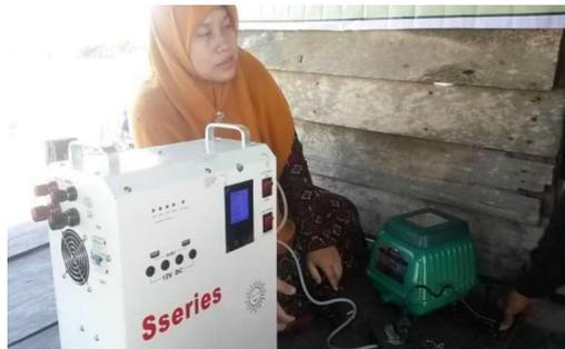
Gambar 5.4 Ujicoba Pompa air yang disambungkan ke baterai solar sel
