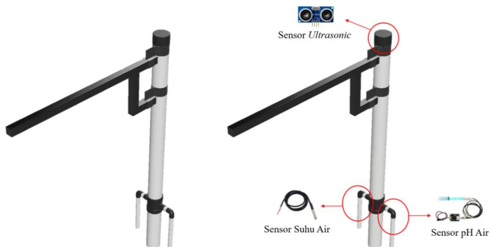
Gambar 2. Desain Mekanik Sistem Monitoring Ketinggian, Suhu, dan pH air
