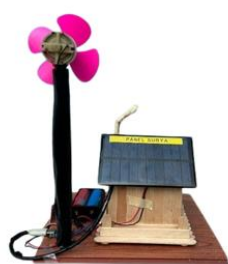
Gambar 2. Ilustrasi prototipe pembangkit listrik hybrid matahari-angin.
