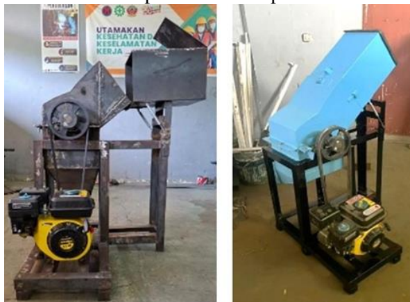
Gambar 3. Pengembangan perancangan desain mesin pencacah es balok
