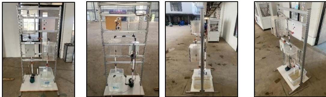
(a) Tampak Depan (b) Tampak Belakang (c) Tampak Samping (d) Tampak Isometri Gambar 3 Modul Pembelajaran Sistem Kendali Perpipaan Berbasis IoT
