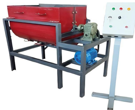
Gambar 3. Hasil Pembuatan Dan Perakitan Komponen Mesin Pencampuran Bahan Briket Arang Tempurung Kelapa
