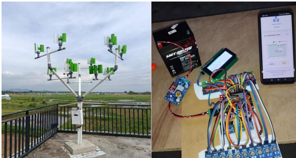
Gambar 4. Hasil Pembuatan Pohon Turbin Angin dan Sistem Monitoring
