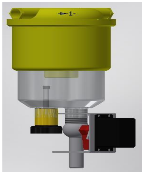
Gambar 1. Desain Alat Water Separator Otomatis
