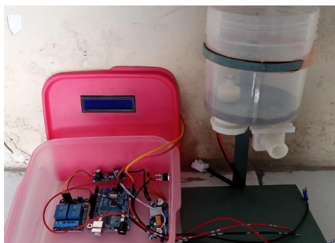
Gambar 3. Hasil Rancang Bangun Alat Pembuka Otomatis Water Separator (prototipe)
